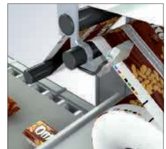
Надежное обнаружение стандартных или полупрозрачных меток при нормальной или высокой скорости движения
