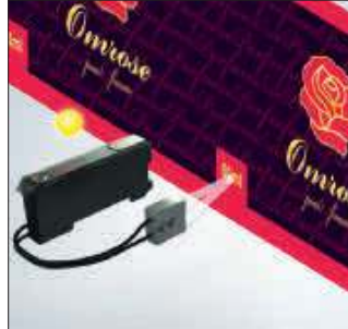
Обнаружение сложных меток совмещения, например с текстовым или графическим содержанием.
